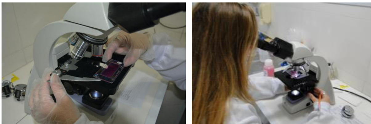
Fotos 3.2.2-1 e 3.2.2-2. Amostra na câmara de Sedgewick-Rafter preparada para análise em e identificação do zooplâncton em microscópio óptico.
