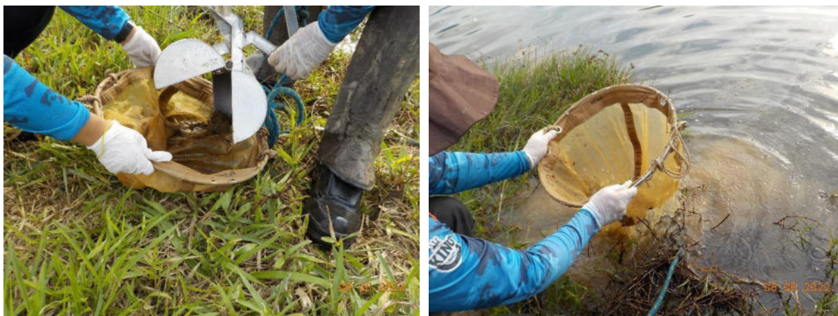
Fotos 3.2.3-1 – Lavagem do sedimento coletado para a análise da comunidade bentônica.
