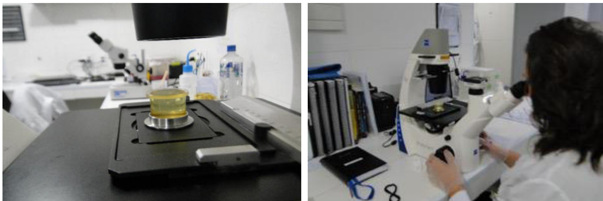
Fotos 3.2.1-2 e 3.2.1-3. Amostra na câmara de sedimentação de Utermöhl e contagem do fitoplâncton em microscópio invertido.
