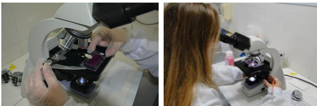
Fotos 3.2.2-2 e 3.2.2-3. Amostra na câmara de Sedgewick-Rafter preparada para análise em e identificação do zooplâncton em microscópio óptico.
